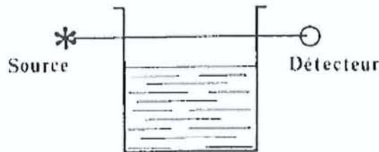
Principe d'une jauge de niveau
