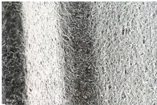
Figure 16: Surface obtenue par sablage à l'oxyde de titane (Davarpanah M S.-M. S., 2012)
