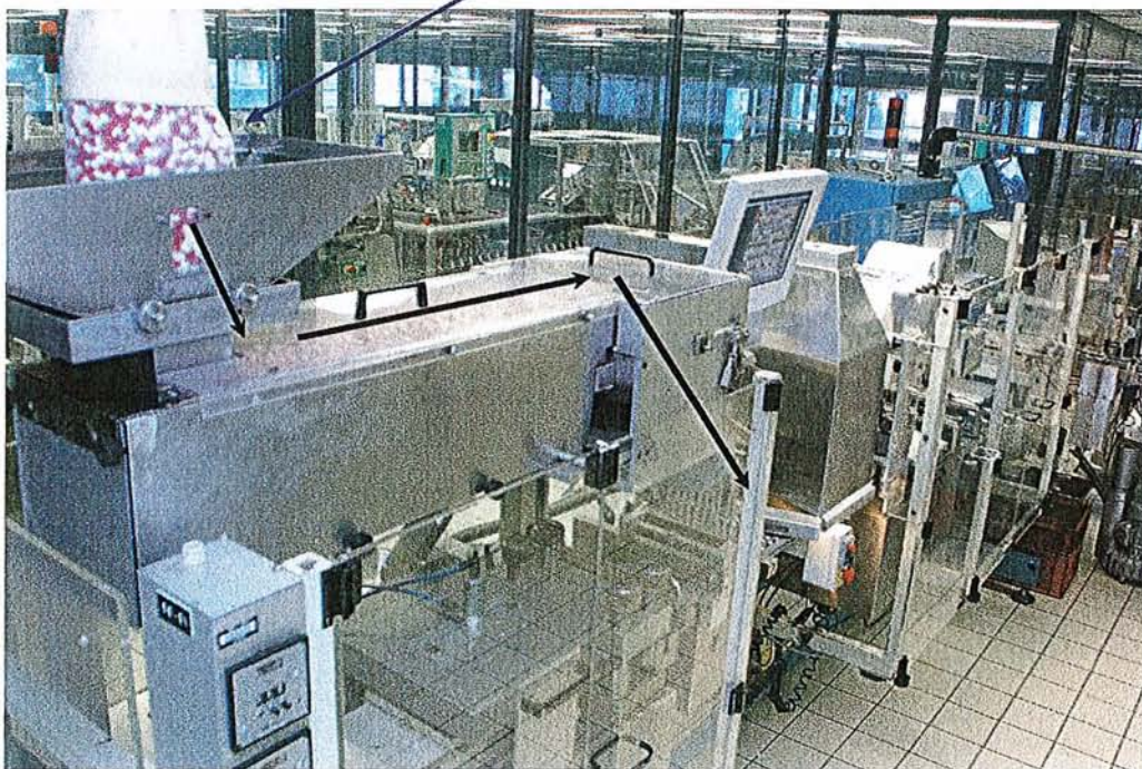
Figure 1 : alimentation de la ligne en gélules
