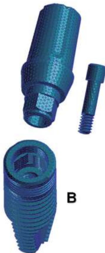
Figure 65 : Illustration d'une connexion cône morse modifiée antirotationnelle à hexagone interne.
