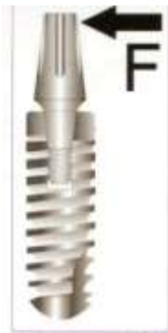
Figure 33 : Application d'une force latérale sur un cône morse. Belveze et Stabik, Stratégie prothétique, 2009.
