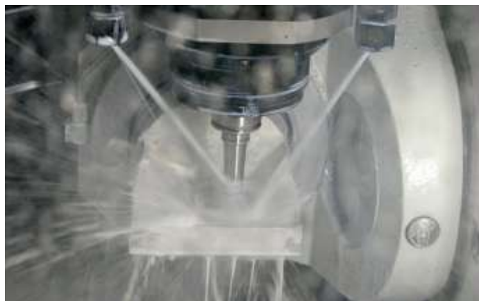
Figure 59: Usinage du pilier. Nobelbiocare.com.
