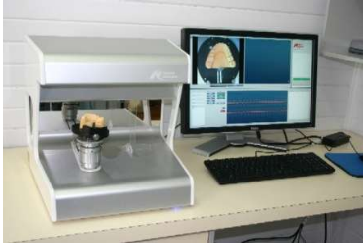
Figure 57: Scanneur holographique conoscopique NobelProcera™. Nobelbiocare.com.
