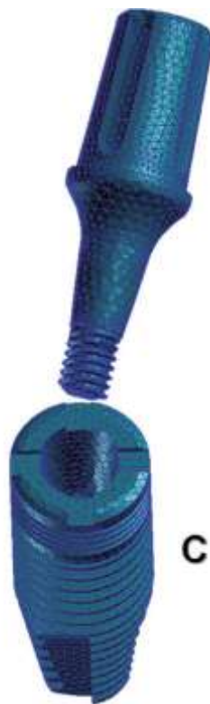
Figure 63 : Illustration d'une connexion cône morse pure.
