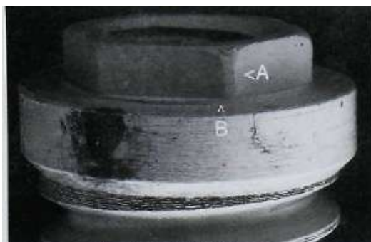
Figure 31: Illustration d'un implant à connexion externe hexagonale, qui était en contact avec un pilier possédant une mauvaise fixation. Binon and McHugh, 1996.
