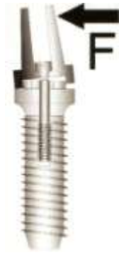
Figure 32 : Application d'une force latérale avec une connexion hexagonale externe. Belveze et Stabik, Stratégie prothétique, 2009
