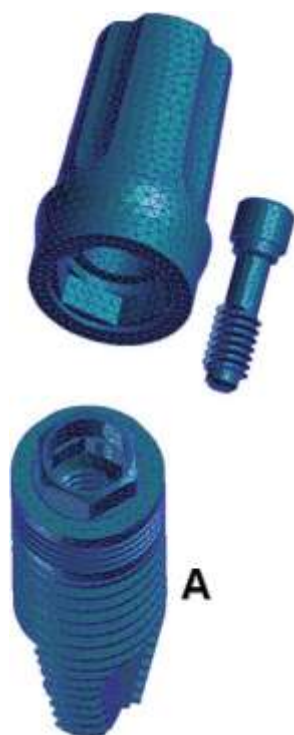
Figure 62 : Illustration d'une connexion hexagonale externe.
