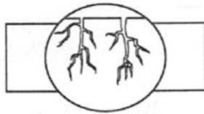
Fig 31. Schéma d'une corrosion sous contrainte, selon [UPADHYAY, 2006].
