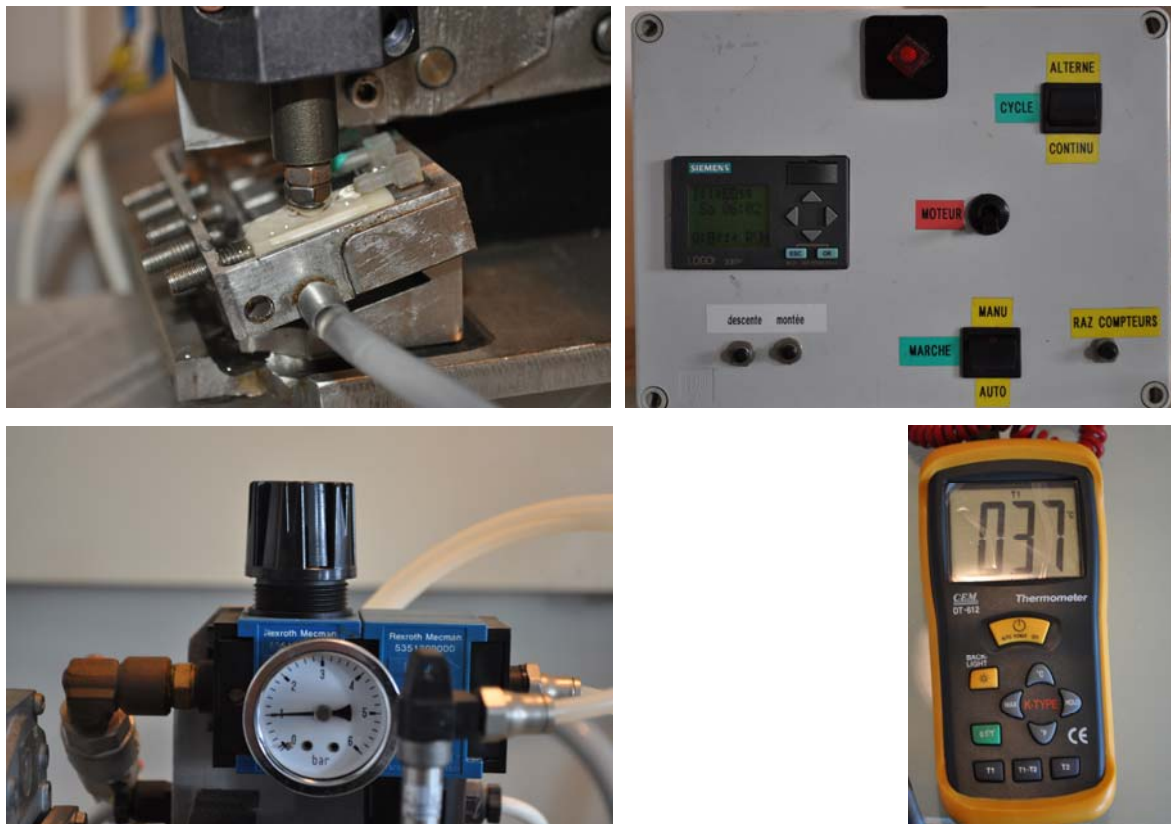
Fig 71. Vue en détail de l'indenteur, du programmateur, du manomètre et de la sonde de surveillance de température.
