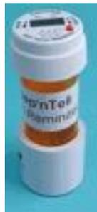
Figure 4 : photo d'un bouchon muni d'une minuterie : Epill Beep'N'Tell®
