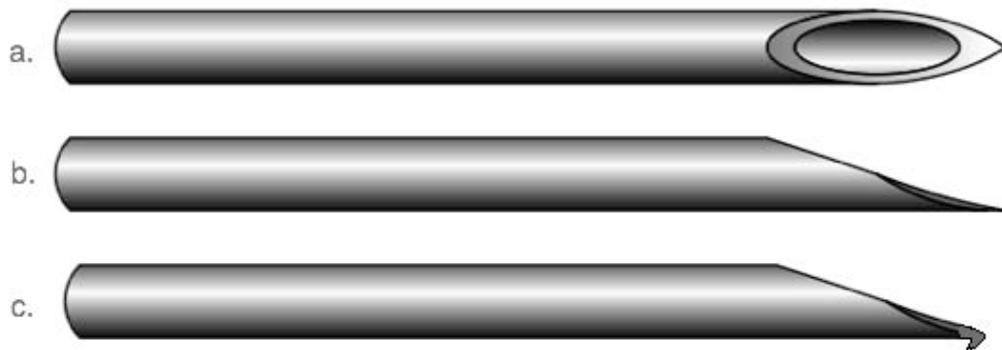
Figure 22 : schémas a et b :aiguille biseautée neuve. Schéma c, aiguille au biseau ébarbé.
