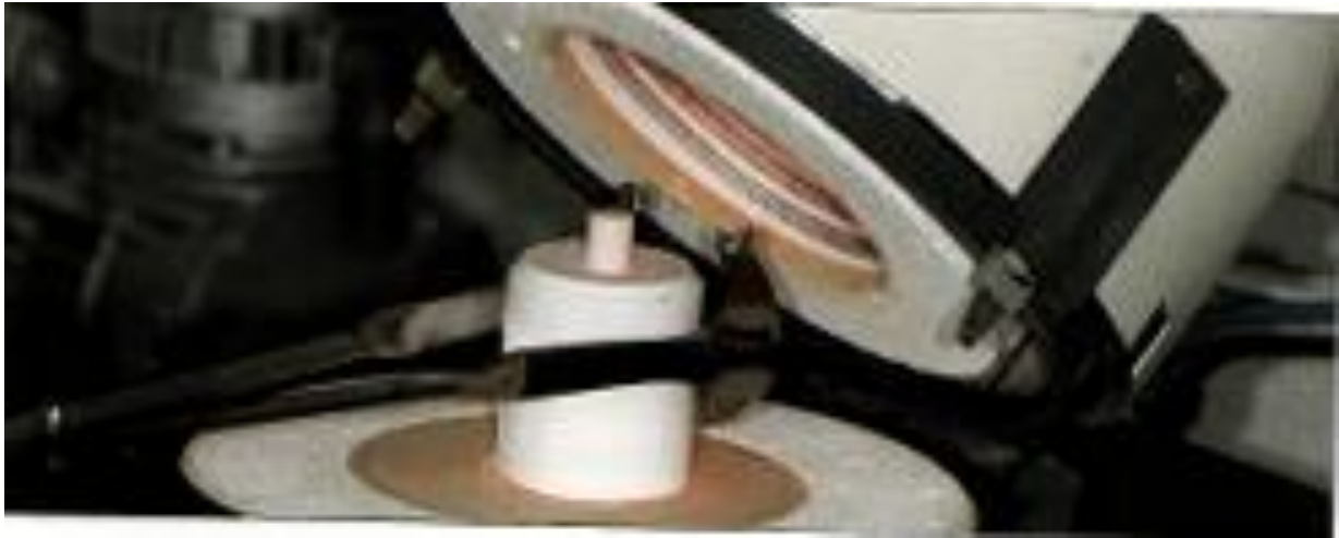
Fig.31 Le four de pressée et le lingotin de céramique à l'intérieur du cylindre en revêtement réfractaire (HÄMMERL ; 2010).
