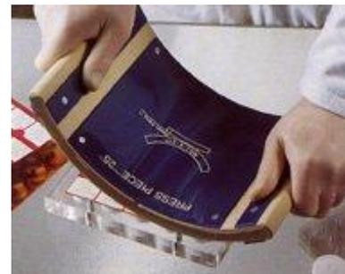
D : Application d'une pression sur le blister scellé afin d'assurer une adhésion complète de l'étiquette aux cupules
