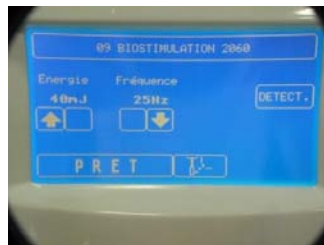
Figure 164. programme de biostimulation (écran du Key3 Kavo)
