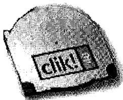
*Commercialisé par Iomega, il s'agit d'une mini disquette de 40 Mo spécialement conçue pour les ordinateurs de poche, dont la taille ne dépasse pas celle d'une PC Card.*
