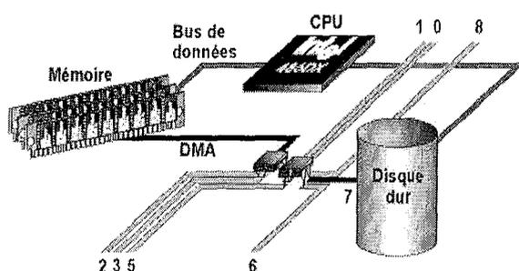
Le DMA est un canal utilisé pour les transferts de données à haute vitesse. Il est souvent désigné sous le nom de canal d'accès direct à la mémoire. Il est utilisé avec les composants nécessitant de gros transferts de données à la plus haute vitesse possible. Un port sériel n'utilisera pas de port DMA, mais une carte réseau en mobilisera souvent un.
