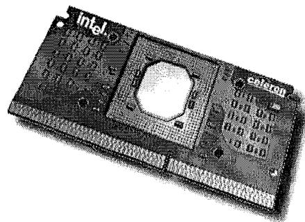
Le format SEP (Single Edge Processor Package) est basé sur celui du Pentium II. Il se présente sous la forme d'une carte qui est insérée verticalement sur la carte mère.
