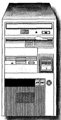
Ce type de boîtier est répandu chez les petits assembleurs. Il offre généralement de bonnes possibilités d'extensions pour un prix réduit. Il permet habituellement l'insertion de 2 composants au format 5¼" et de 3 au format 3½".
