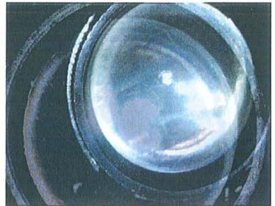
Mise en place de la lentille grand champ du système à vision panoramique
