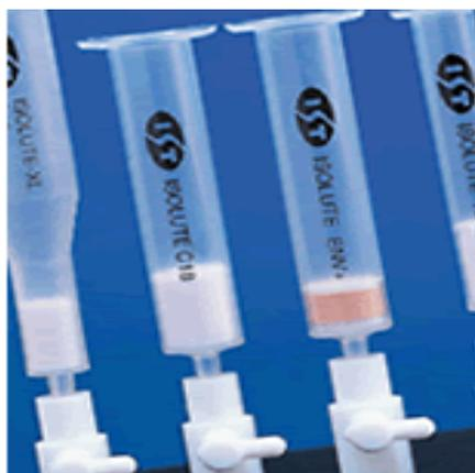
**Figure 23 : Cartouche utilisée pour une SPE** (45)
