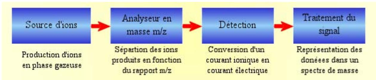
**Figure 29 : Structure d'un spectromètre de masse (51)**
