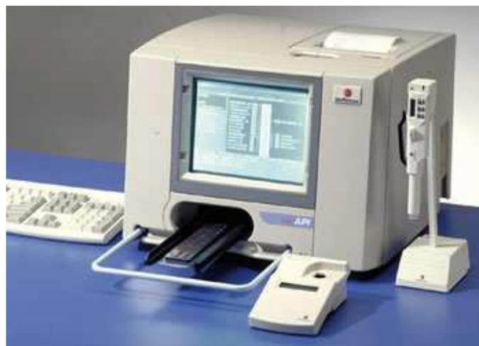
**Figure 8. Semi-automate mini API<sup>®</sup>** (d'après 83)
