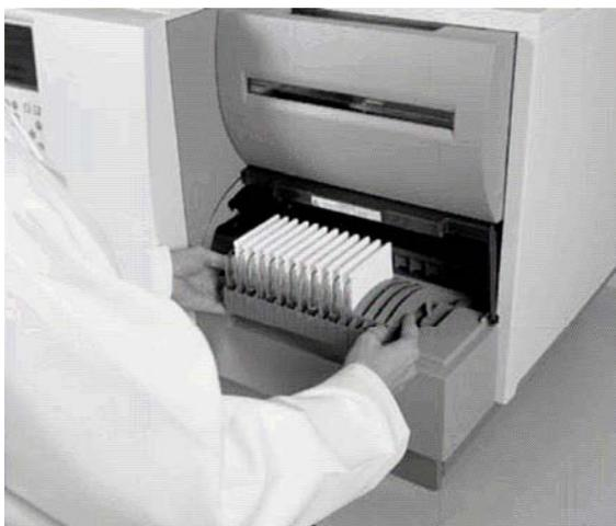
**Figure 21. Chargement d'une cassette dans le Vitek® 2 (107)**
