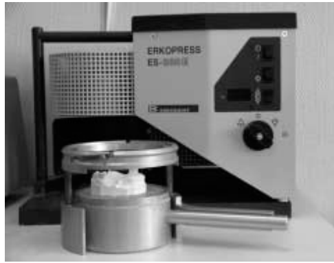
Fig.41 : mise en place du modèle en plâtre dans l'appareil à thermoformer. (56)
