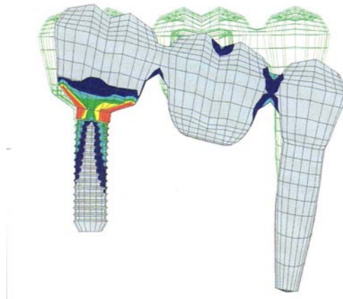
Schéma 13: Analyse des éléments finis montrant les déplacements respectifs d'une dent et d'un implant quand ils sont reliés par un bridge. 67
