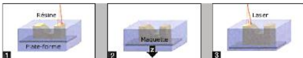
Figure 39 : Schéma de la stéréolithographie
