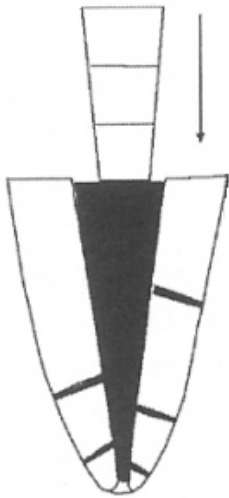
Figure 3. Thermocompactage. Compactage vertical (Dossier de l'ADF 2003).
