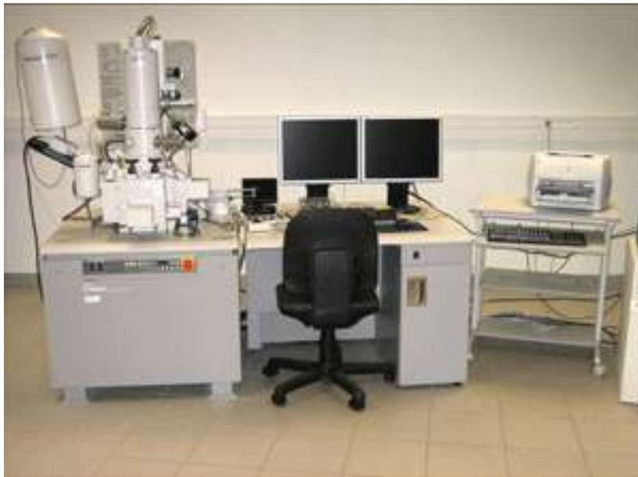
Figure 35 : Microscope électronique Hitachi S4800
