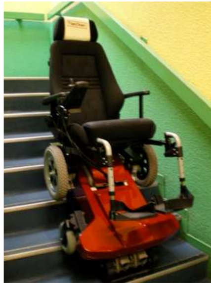
Figure 16 - Le fauteuil électrique monte-marche (d'après fauteuil roulant monte-marches disponible sur le site sur http://www.hacavie.com/2008/06/ consulté le 03 octobre 2010).
