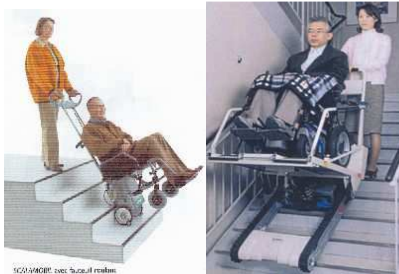
Figure 15 - les franchisseurs d'escaliers, d'après franchisseurs d'escalier disponible sur le site http://www.handicat.com consulté le 14 octobre 2010 à gauche : à roues (à l'adresse http://www.handicat.com/at-num-557.html ) à droite : à chenillettes (à l'adresse http://www.handicat.com/at-num-7726.html ).
