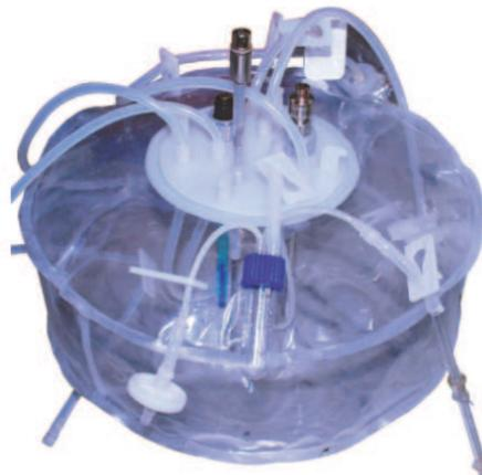
FIGURE 2.11 – Photographie d'un réacteur « à usage unique » de 50L équipé d'une sonde de pH, de température et de pO<sub>2</sub> [?]
