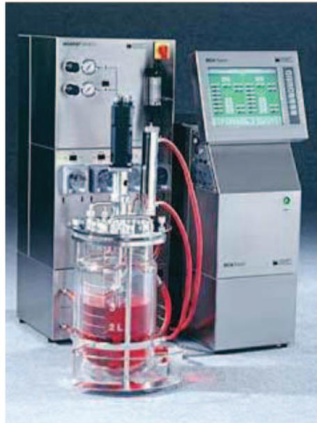
FIGURE 2.2 – Bioréacteur en verre 5L, BIOSTAT B-DCU® Single version [?]
