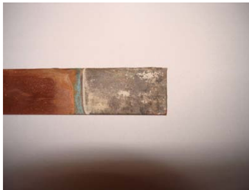
Figure 72 Dépôt brulé d'argent sur la lame de cuivre
