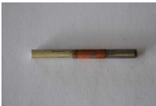
Figure 74 Dépôt d'argent sur un barreau de titane avec flash de cuivre
