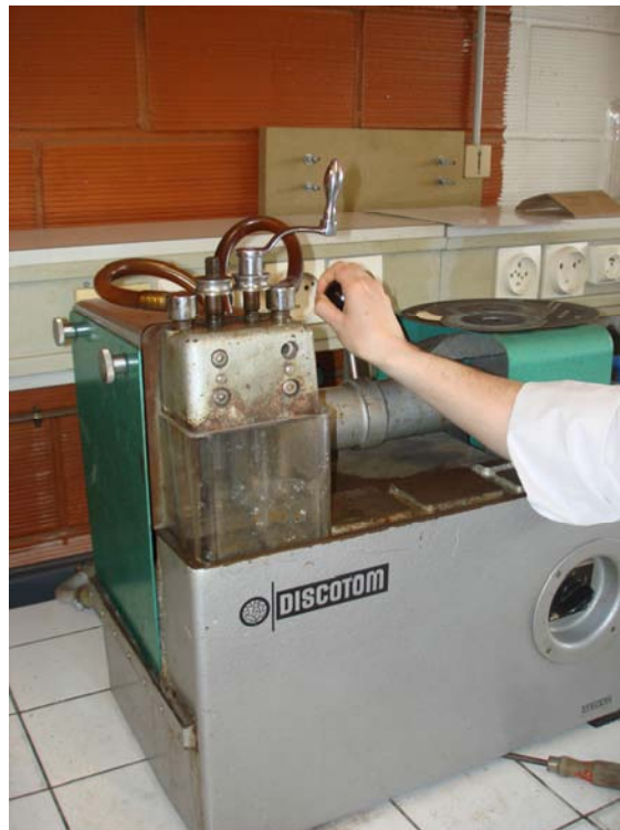
Figure 54 Découpage des échantillons
