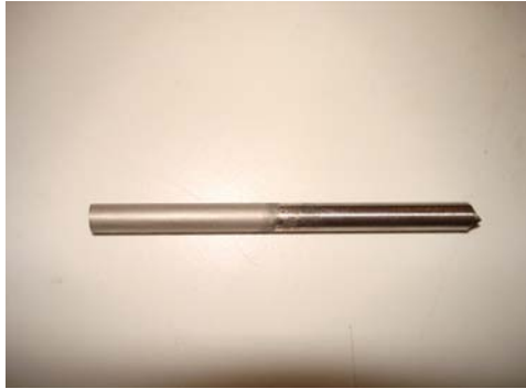
Figure 69 Dépôt de nickel sur le barreau de titane
