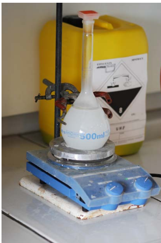
Figure 59 Agitation de 36h à température ambiante (la solution reste trouble)
