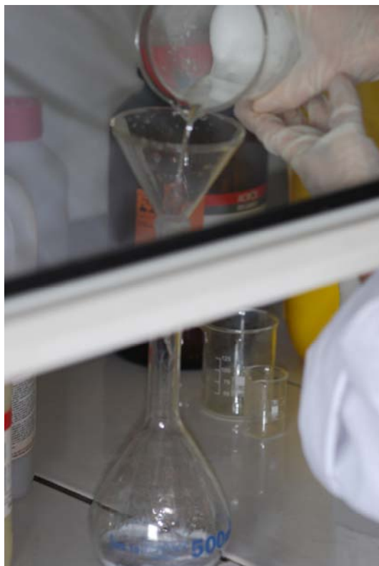
Figure 58 Mélange du KI pré-dissout avec l'ammoniac et le sulfate d'argent.
