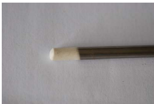
Figure 75 Dépôt argent seul sur le titane
