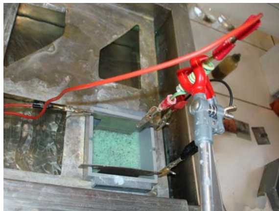
Figure 68 Installation pour le nickelage
