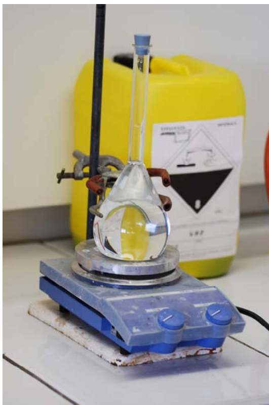
Figure 61 Solution filtrée (on peut remarquer la transparence de la solution)
