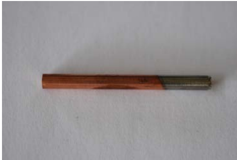
Figure 70 Dépôt de cuivre sur le titane.
