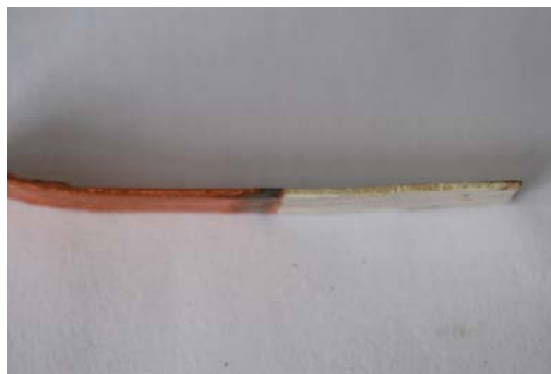
Figure 73 Dépôt non brulé d'argent sur la lame de cuivre
