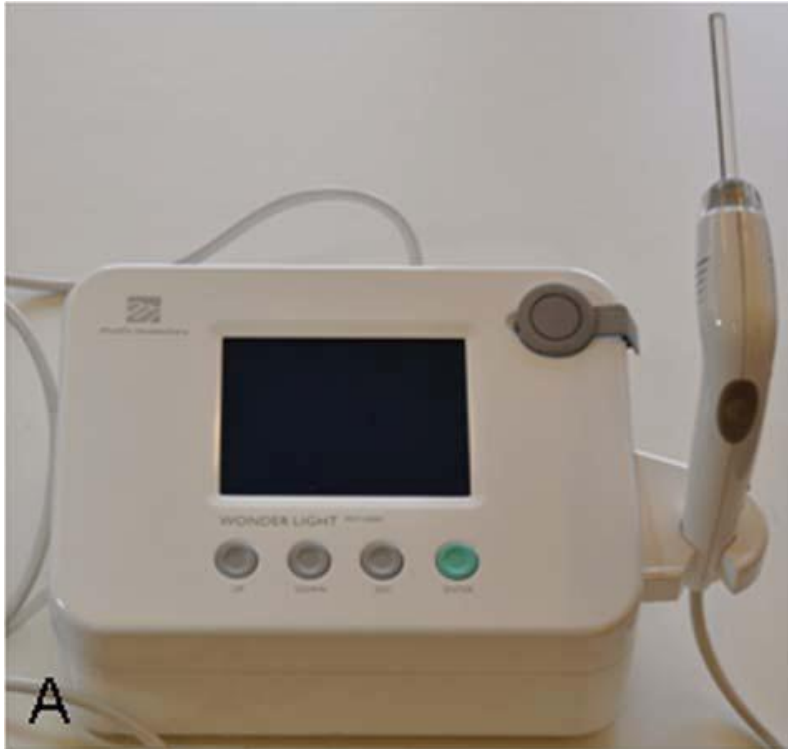
Figure 9 Le système Wonder Light LED : la densité de puissance est réglable allant de 1 à 400 mW/cm 2 et la densité de puissance a été fixée à 320 mW/cm 2 dans l'étude de [21]
