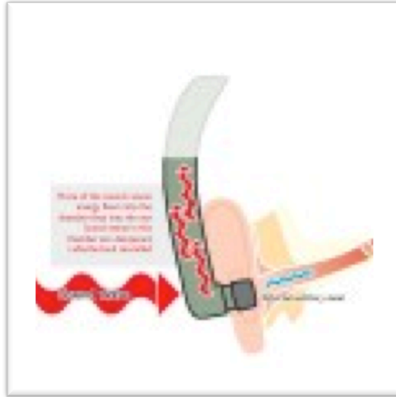
Figure n°51 : Schéma de la technologie de chambre sonore du Pro10 de NAPIER
