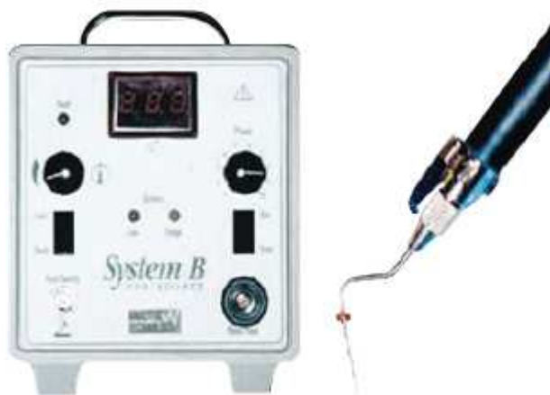
Figure 47 : boîtier électrique et pièce à main du Système B® (Péli et Oriez, 2010).
