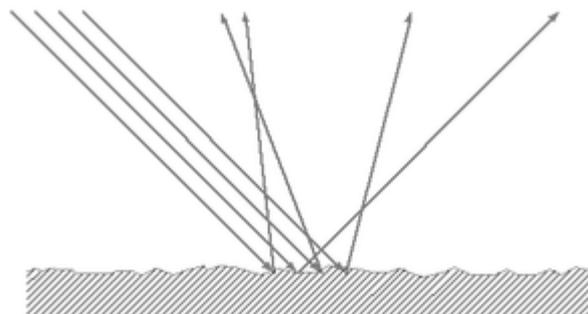
Fig. 1.2.6.5 : Diffusion de la lumière sur une surface rugueuse
