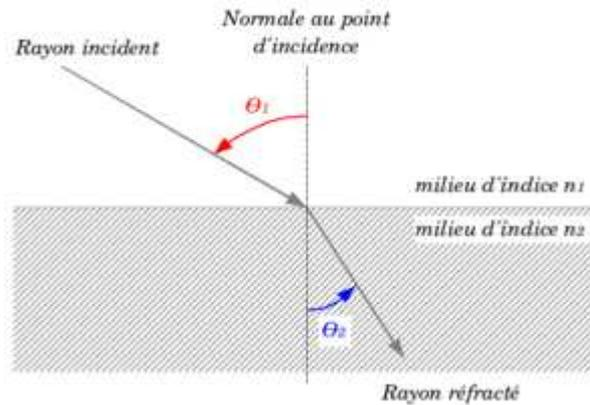
Fig. 1.2.6.1 : Schéma de la réfraction de la lumière
