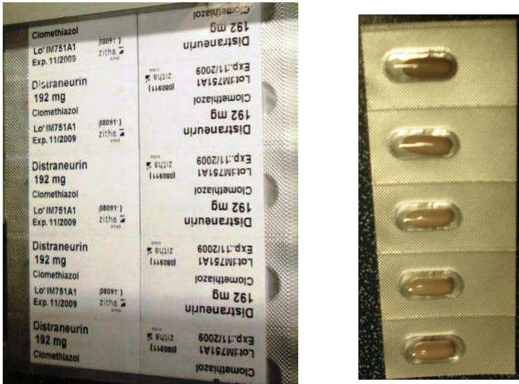
Figure 35 : Blister réalisé par la reconditionneuse
