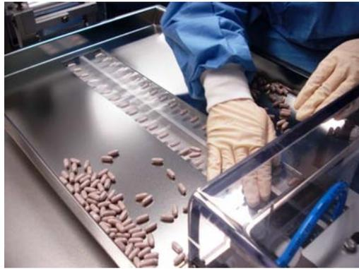
**Figure 33 : L'opérateur place les gélules dans les alvéoles**
