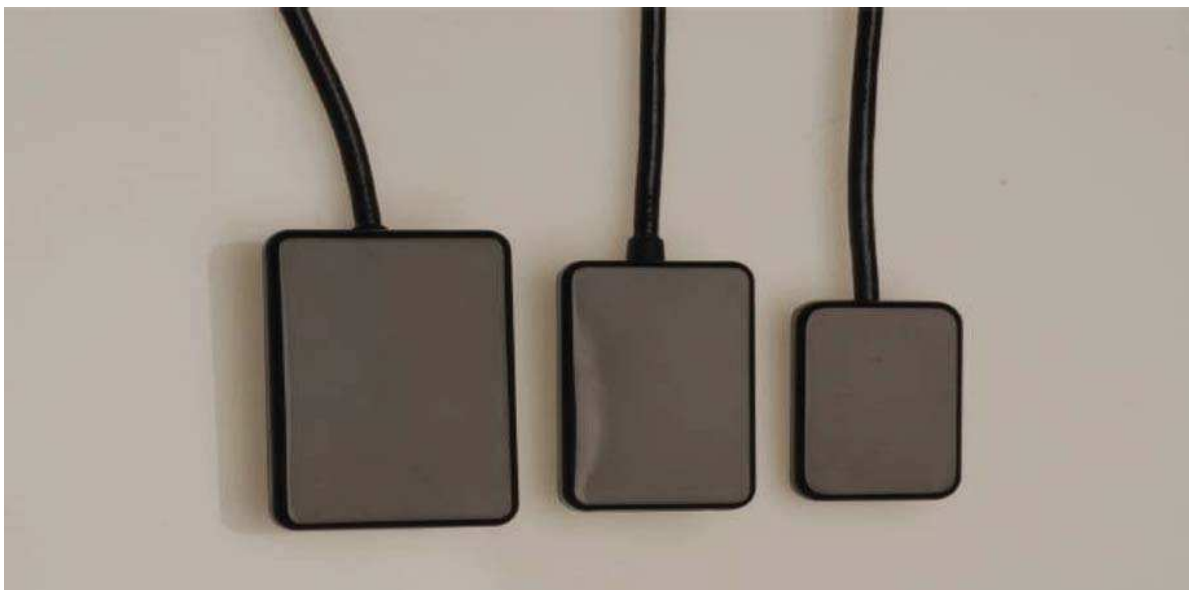
Fig.24 : Capteurs CCD de différents formats [59]
