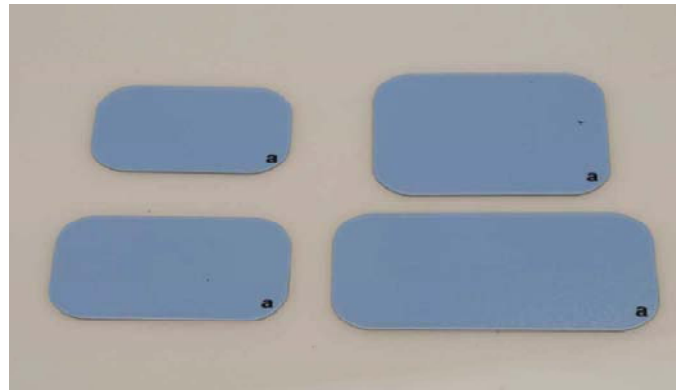
Fig.26 : Exemple de capteurs ERLM de différents formats [59]
