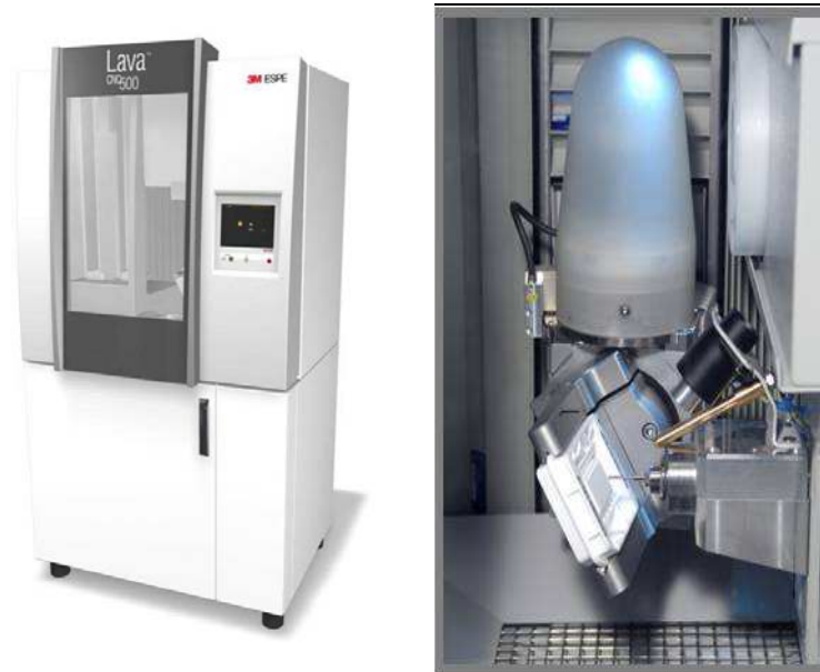
Figure 117. Fraiseuse Lava™ CNC 500 à 5 axes (3M ESPE). (100)
