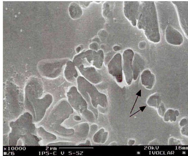
Figure 23. Céramique feldspathique traditionnelle au MEB. (26)
