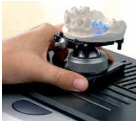
Figure 116. Déplacement libre du modèle sur une plaque de positionnement ou recours aux rails intégrés facilitant la numérisation des bridges.
