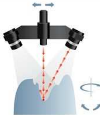
Figure 131. Scanner 3D 700™ 3Shape. Un laser unique pour une double caméra. (151)
