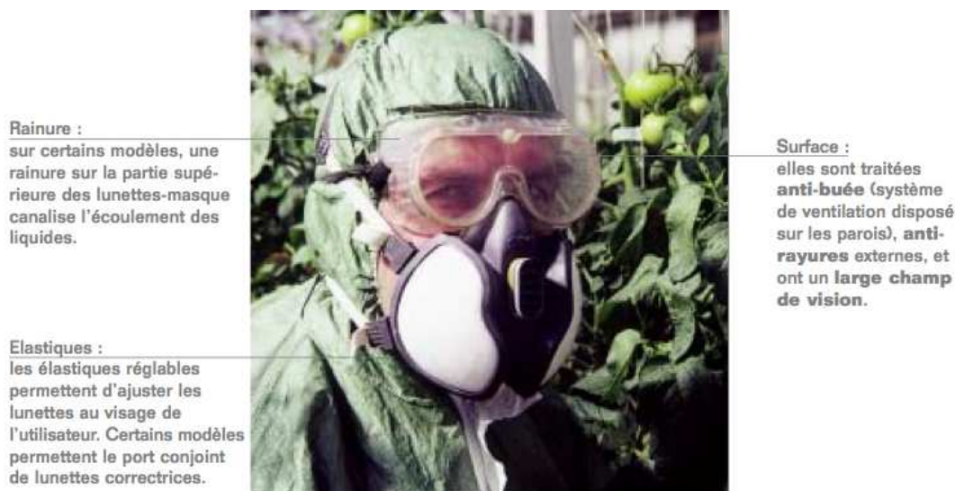
Figure 34 : Caractéristiques des lunettes-masque. Source : MSA, 2001.
