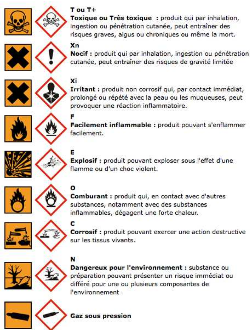
Figure 30 : Pictogrammes de danger pour l'étiquetage des produits chimiques ; à gauche les anciens pictogrammes, à droite les nouveaux pour la réglementation CLP. Source : INERIS.
