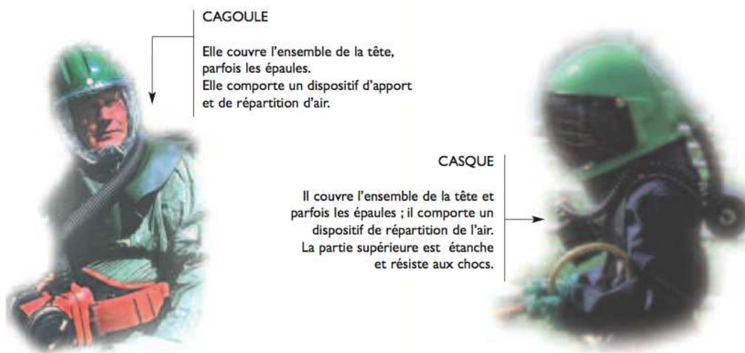
Figure 33 : Appareils de protection respiratoire filtrants à ventilation assistée. Source : MSA, 2000.
