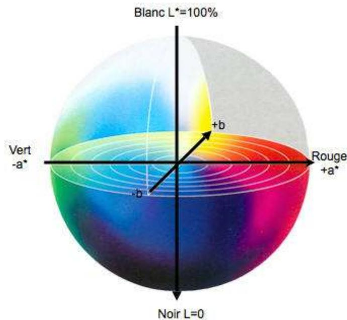
Figure 1 : Représentation des couleurs dans le système «  $L^*$ ,  $a^*$ ,  $b^*$  »
