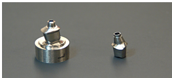
Fig. 41 : Piliers implantaires en titane (Atlantis, Astra) avant et après la séparation du cylindre de titane dans lequel il a été usiné. (106)
