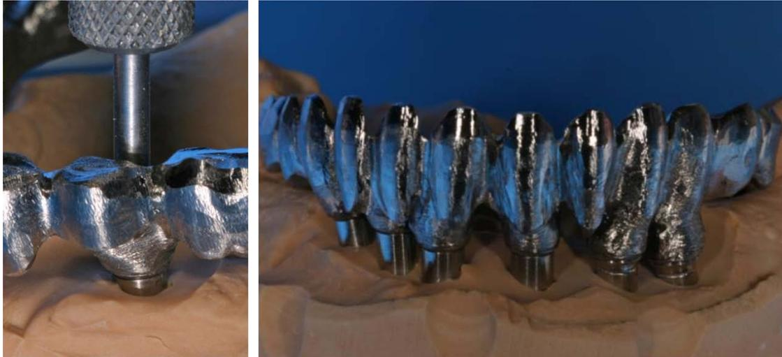
Fig. 90 : Armature terminée, replacée sur le modèle. (2)
