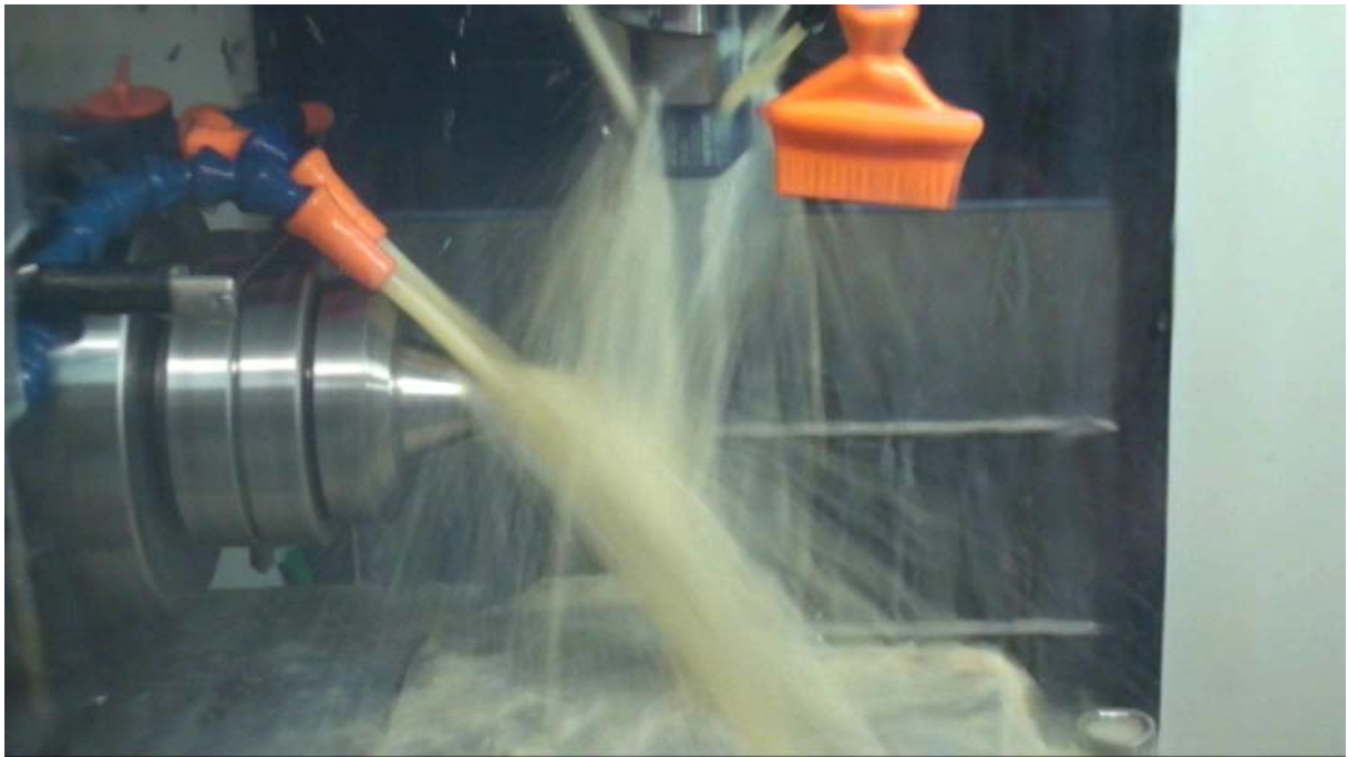
Fig. 20 : Unité d'usinage Astra pour piliers Atlantis en titane en Suède. (106)
