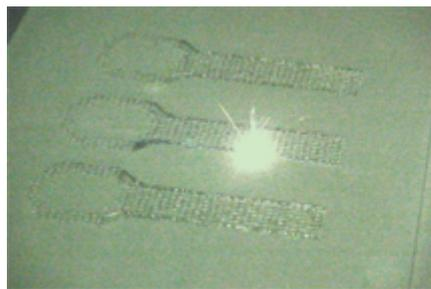
Vu du procédé de micro-fusion sélective de poudre par laser en cours de fabrication
