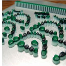
Exemples de production d'armatures calcinables par fabrication additive avec la machine ProJet 3000 DDP de 3D Systems
