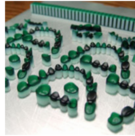
Fig. 56 : Exemples d'armatures calcinables par fabrication additive. (107)
