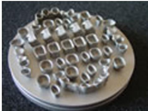
Exemple de production avec la PM100T de Phenix Systems
