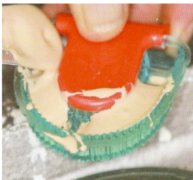
Figures 93 : Repositionnement de l'insert sur l'empreinte après coulée au plâtre -pierre.
