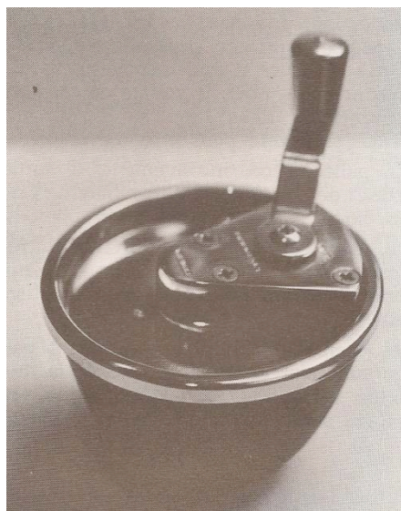
Figure 9: Dispositif à manivelle pour malaxage manuel du plâtre. (11)
