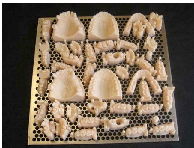
Figure 152 : Modèles de travail en polyuréthane obtenus par S.L.A., sur leur plateau et étais. (28)
