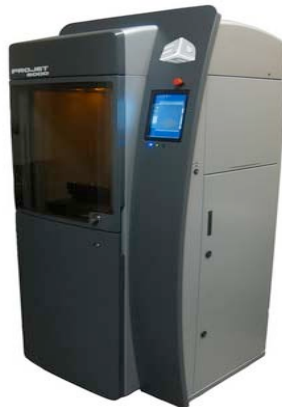
Figure 151 : Imprimante 3D stéréo-lithographique « Projet MP 6000 ».
