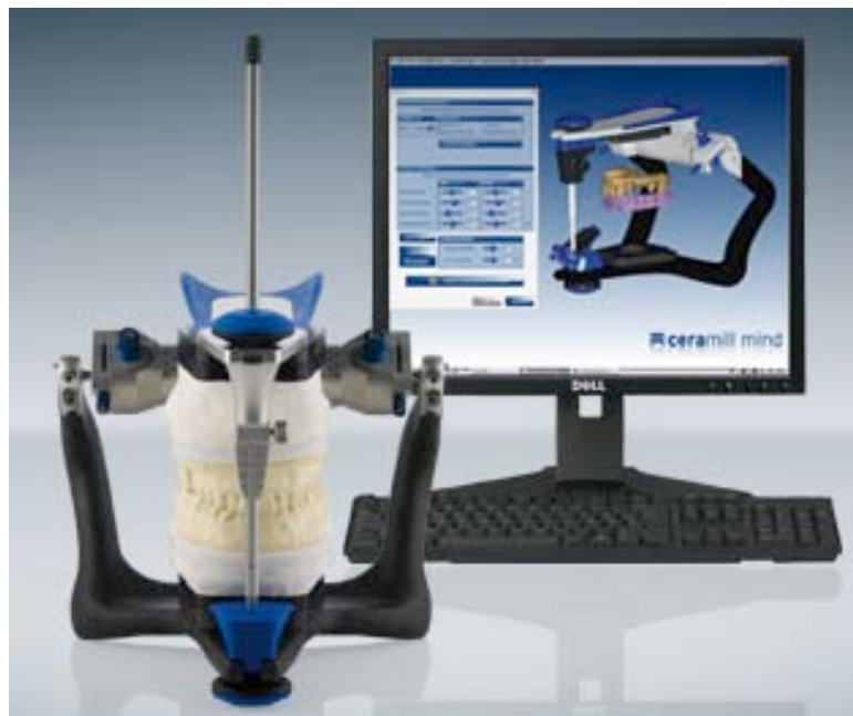
Figure 142 : L'articulateur virtuel « artex » et son pendant physique. (28)
