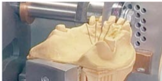
Figure 79: Fractionnement mécanique du modèle à la scie circulaire model-cut.
