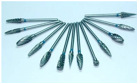
Figure 23: Assortiment de fraises à ébarber en carbure de tungstène.
