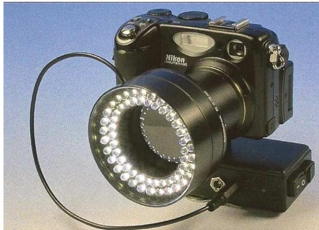
Figure 18 : Système d'éclairage à L.E.D. Med-eye© (BENGUEL, 2006)
