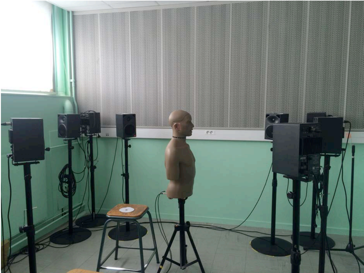
Figure 27 : Aménagement de la salle insonorisée
