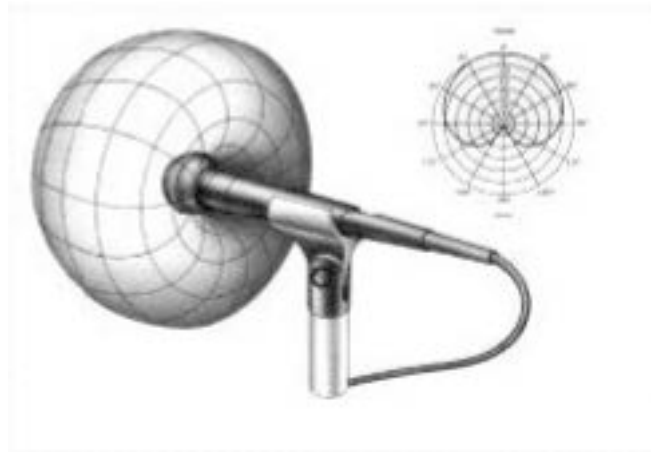
Figure 14 : Diagramme polaire d'un microphone directionnel [Site internet : http://www.claudegabriel.be/Acoustique , consulté en juillet 2015]
