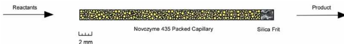
Figure 12 : représentation schématique d'un microréacteur à lit fixe
