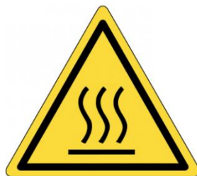
Figure 7 : Panneau de danger risque surface chaude
