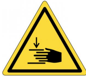
Figure 9 : Panneau de danger risque d'écrasement
