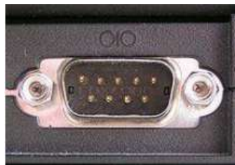
Figure 6 : Exemple d'un détrompeur de contact (Muller, 2013)
