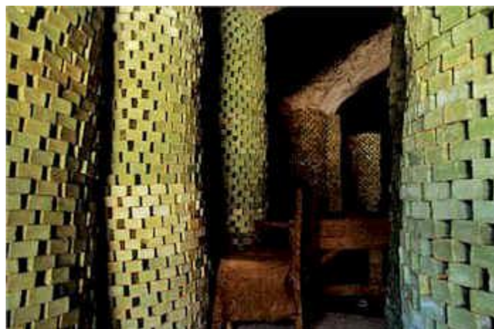
Figure 51 : Séchage en tours cylindriques du savon d'Alep (aroma-zone)
