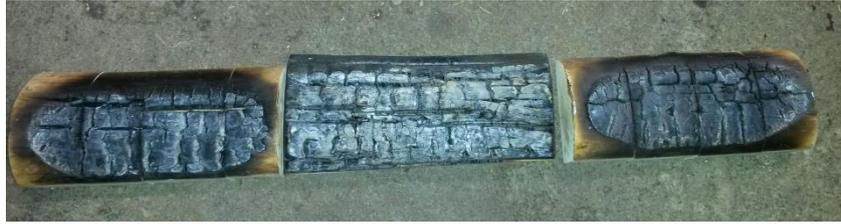
Photographie 17 : Comparaison des bûches à 27% d'humidité avec une bûche à 10% au centre
