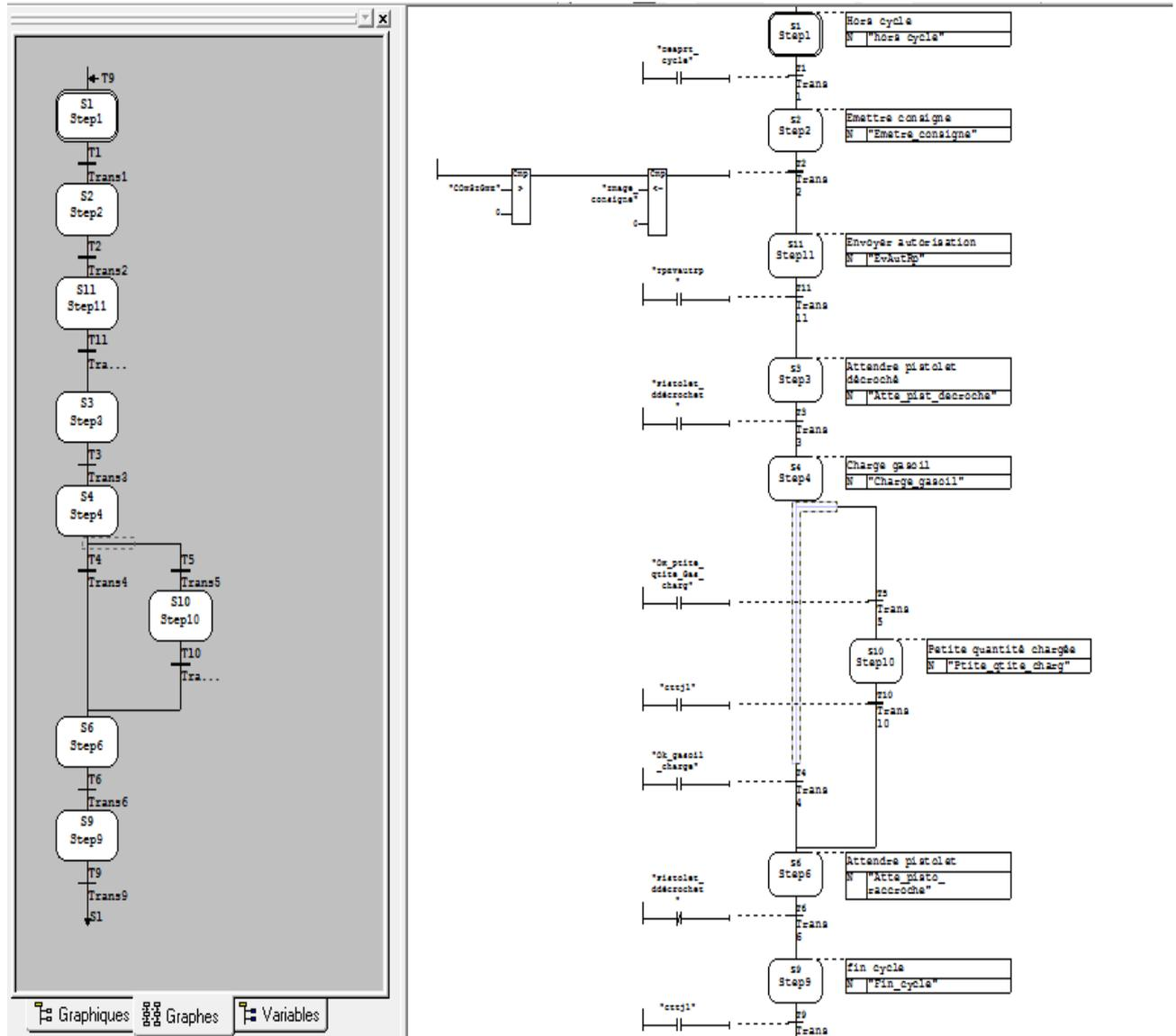
**Fonctions : Séquence de remplissage et Autorisation remplissage et émission consigne gasoil**
