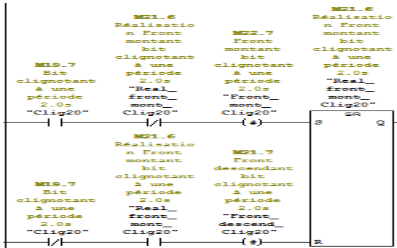
Réseau 11 : Realisation front montant
