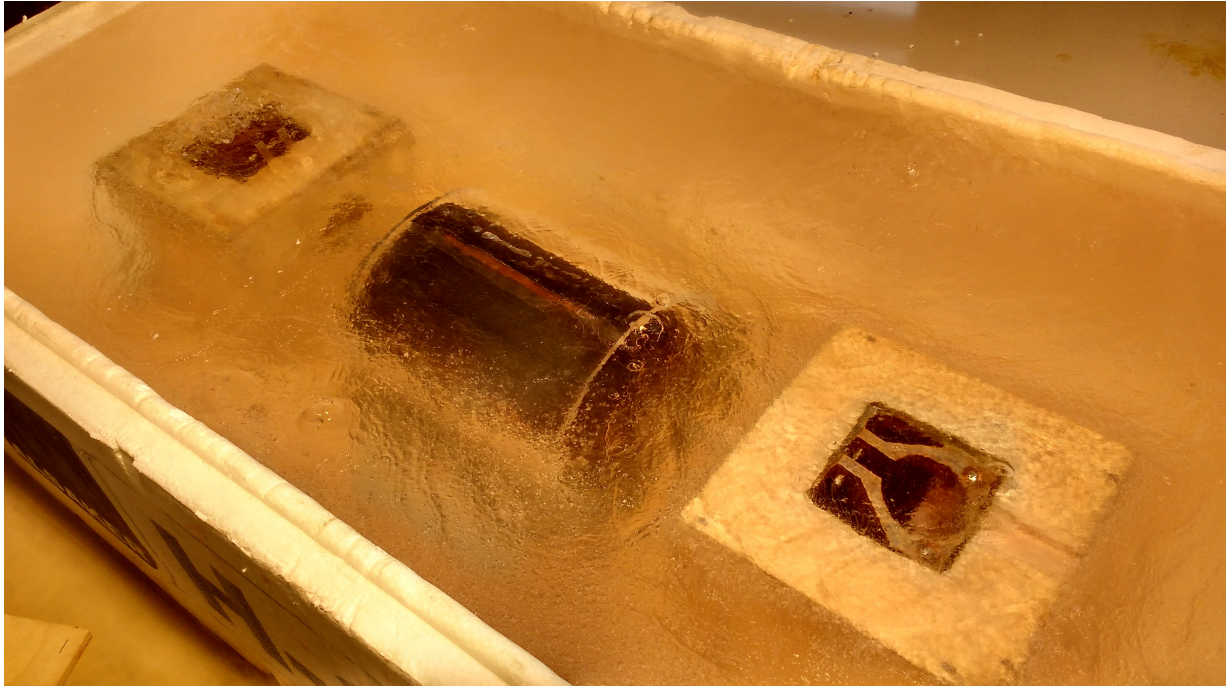
FIGURE 5.18: Moteur couvert par un cylindre creux en plexiglas et plongé dans l'azote liquide
