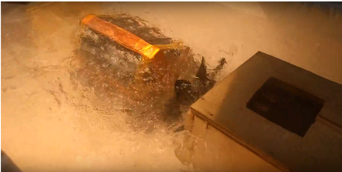
FIGURE 5.16: Moteur fonctionnant dans l'azote liquide
