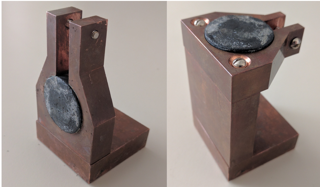
FIGURE 5.5: Support de la pastille supraconductrice verticale à droite, et horizontale à gauche
