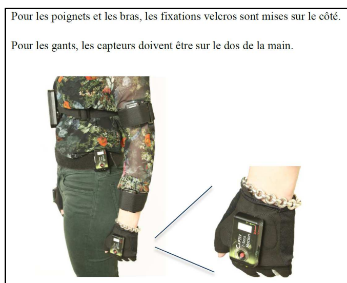
Figure 5 : Document TEA pour le placement de capteurs T-MOTION sur le bras.
