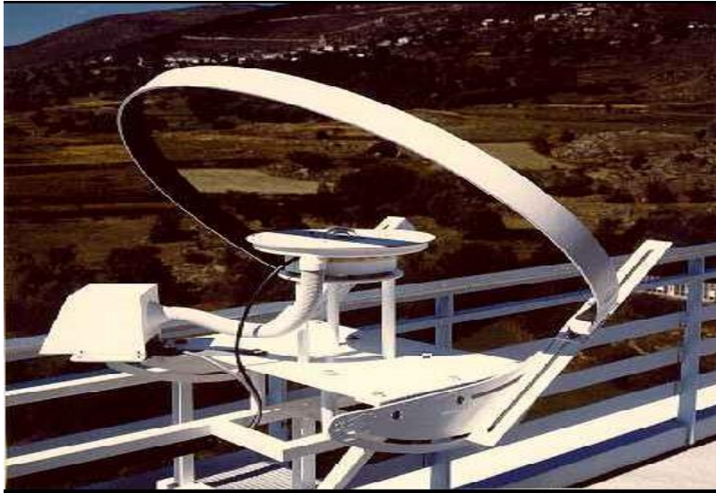
Figure (1-24) : Pyranomètre avec anneau d'ombrage
