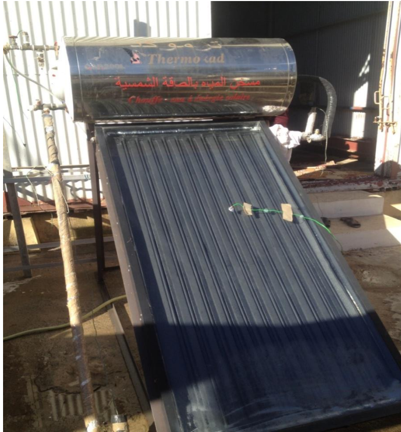
Figure (5-4) disposition des thermocouples dans le système
