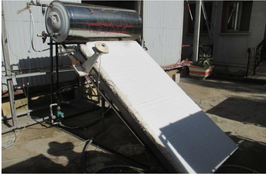
Figure (5-10) : isolation du capteur pour le test de la constante solaire
